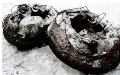
Рисунок 11 – Внешний вид силовой вставки (а) и сетчатых демпферов (б) (ТЭ 17 кг ВВ)
